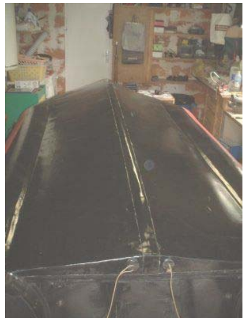
Découper la toile PVC en deux parties symétriques et effectuer le collage en plusieurs fois.
