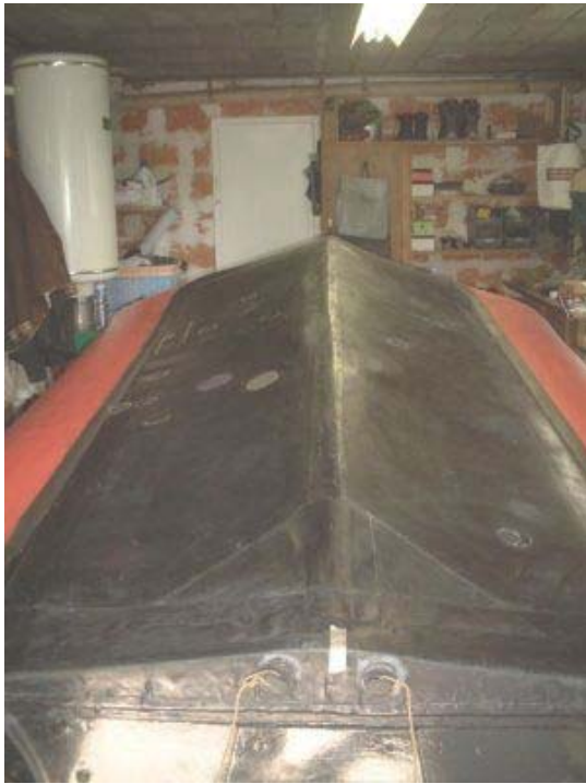
Bien dégraisser la totalité du fond et nettoyer les vieilles réparations
