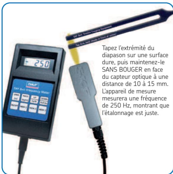
Tapez l'extrémité du diapason sur une surface dure, puis maintenez-le SANS BOUGER en face du capteur optique à une distance de 10 à 15 mm. L'appareil de mesure mesurera une fréquence de 250 Hz, montrant que l'étalonnage est juste.
