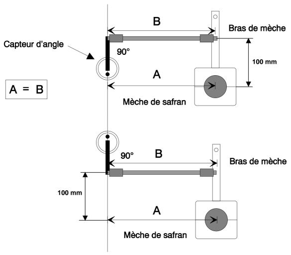
Le capteur peut être monté vers l'avant, vers l'arrière, à babord ou à tribord. Le calculateur reconnaîtra la position lors de l'initialisation.
