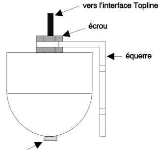
vis de blocage ou d'étanchéité
