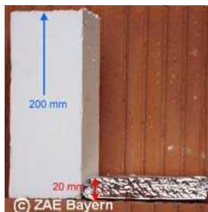
Figure 5 : Comparaison épaisseur isolant classique - isolant sous vide
